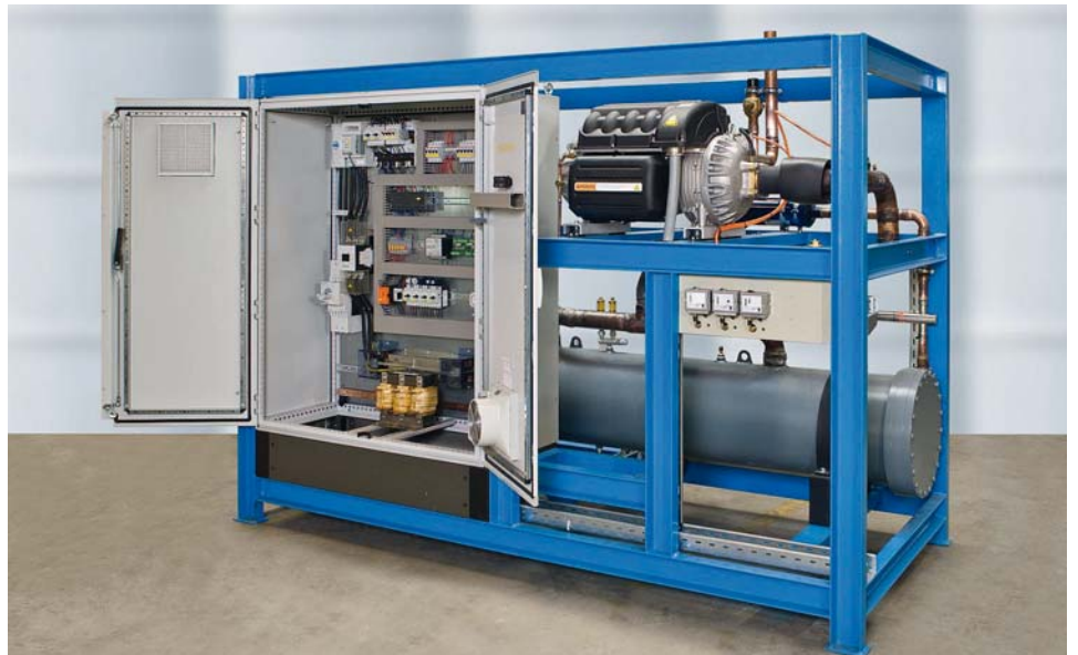
Kompakt und leistungsstark: Dieses Maschinengestell beherbergt ein komplettes 300-kW-Epsilon-System inklusive Schaltschrank
